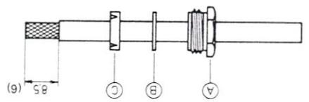
Nippel A, Scheibe B und Dichtung C auf das Kabel schieben. Kabel gemäss Figur absisolieren (6 mm für Winkelverbinder). ACHTUNG: Abschirmung nicht beschädigen!
