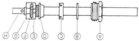
Pressring E, Isolator F und G aufsetzen.
