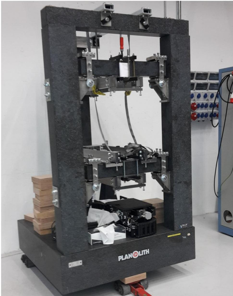
**Abbildung 6: XY-Teststand zur Vermessung der Position der elektrischen Null bzgl. der mechanischen Referenz sowie der Sensitivität von Strahlagemonitoren (BPM).**
