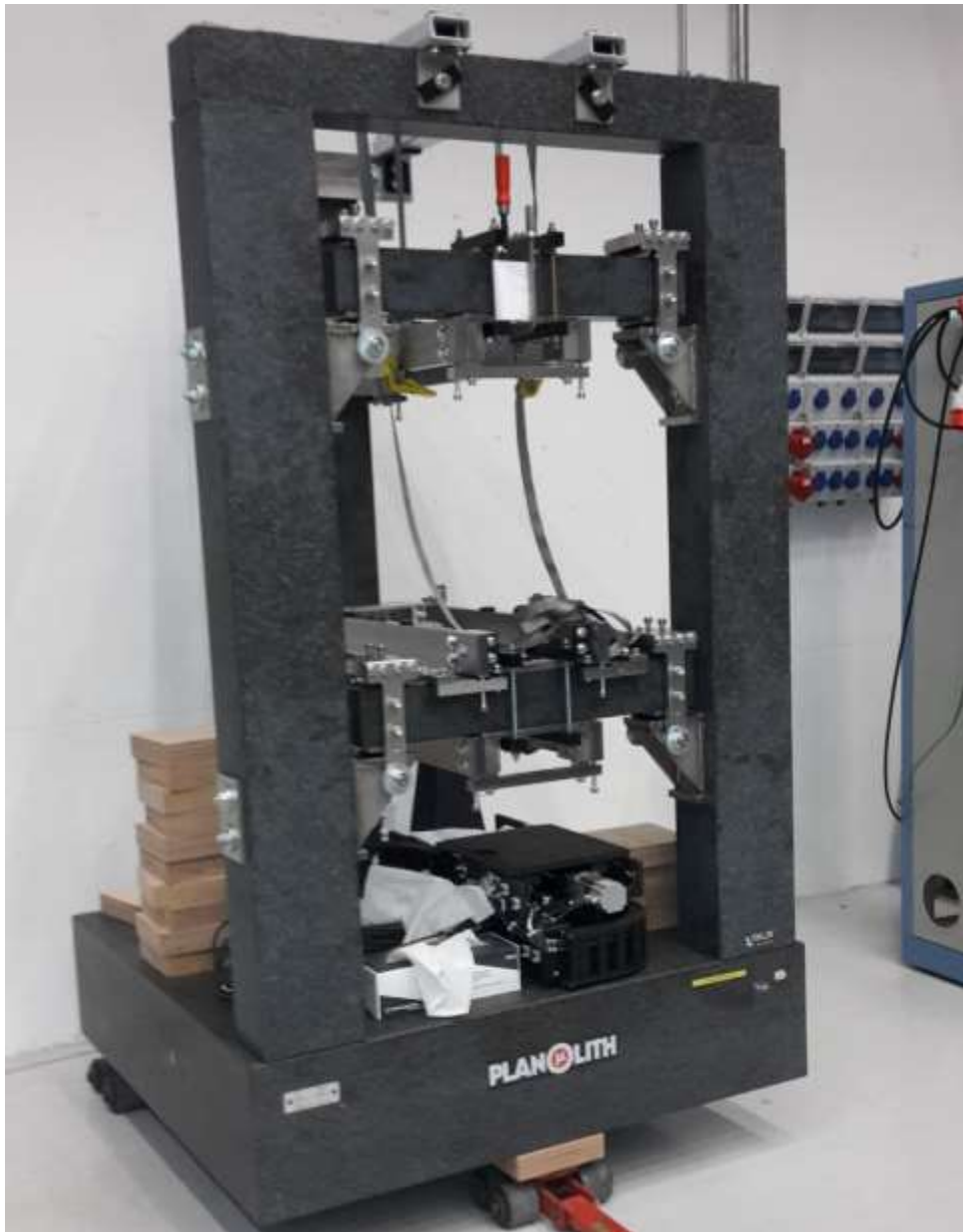
Abbildung 5: XY-Tisch zur Vermessung der Position der elektrischen Null bzgl. der mechanischen Referenz sowie der Sensitivität von Strahlageemonitoren (BPM).
