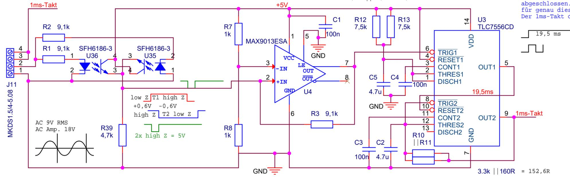
Aus einem externen 9 VAC-Netzteil wird einmal pro Crate eine 50 Hz-Freuzenz abgenommen und niederohmig abgeschlossen. Deren Nulltransfer triggert einen lms-Takt für genau diese Periode der Netzfrequenz. Der lms-Takt dient der real-time synchronen Anzeige der Messbereiche!
