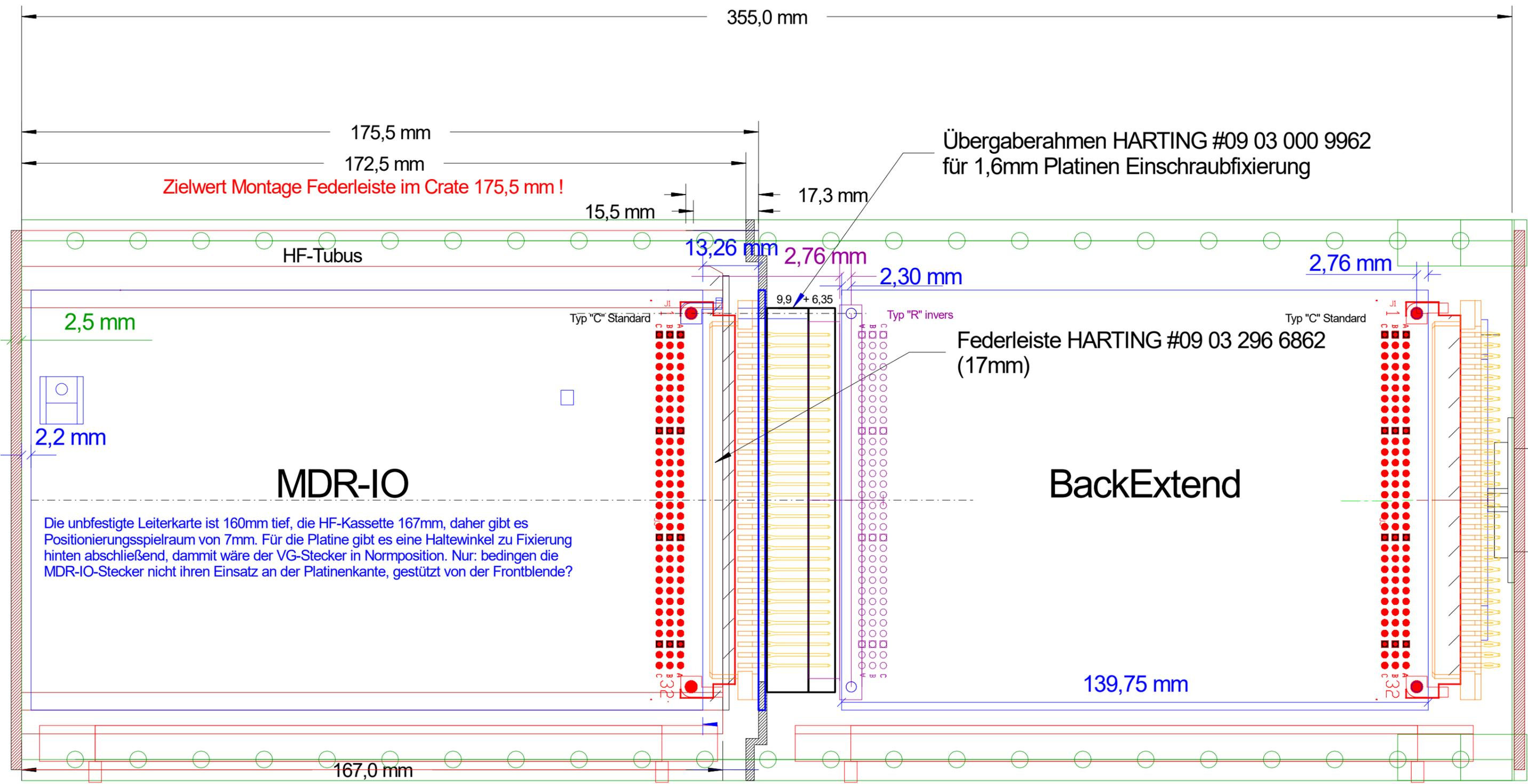
Die unbefestigte Leiterkarte ist 160mm tief, die HF-Kassette 167mm, daher gibt es Positionierungsspielraum von 7mm. Für die Platine gibt es eine Haltwinkel zu Fixierung hinten abschließend, damit wäre der VG-Stecker in Normposition. Nur: bedingen die MDR-IO-Stecker nicht ihren Einsatz an der Platinenkante, gestützt von der Frontblende?
