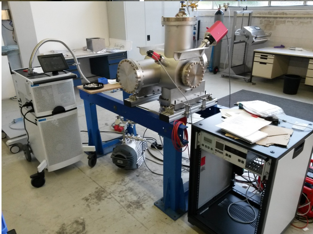
Abbildung 2: Ansicht der beiden Vakuum-Teststände (oben) sowie Gesamtaufbau des Vakuum-Teststands für Abnahmemessungen
