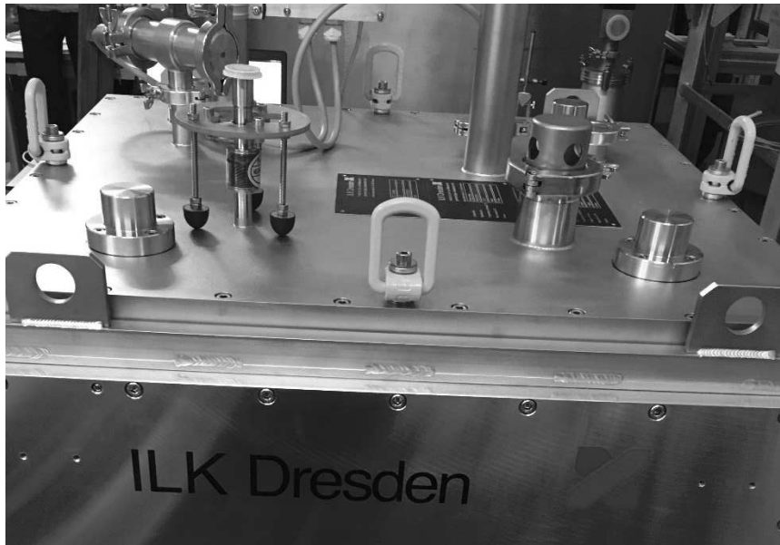
Abbildung 3: Oberseite des Kryostaten mit vier angeschweißten Hebelaschen am Vakuumbehälter und vier Hebelaschen (gelb) zum Heben des Vakuumdeckels mit Heliumbehälter und Thermischem Schild
