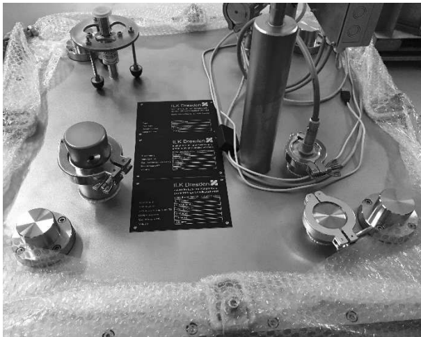
Abbildung 15: Vakuum-Deckelansicht; links neben den Typenschildern: Überdruck-Sicherheitsstopfen
