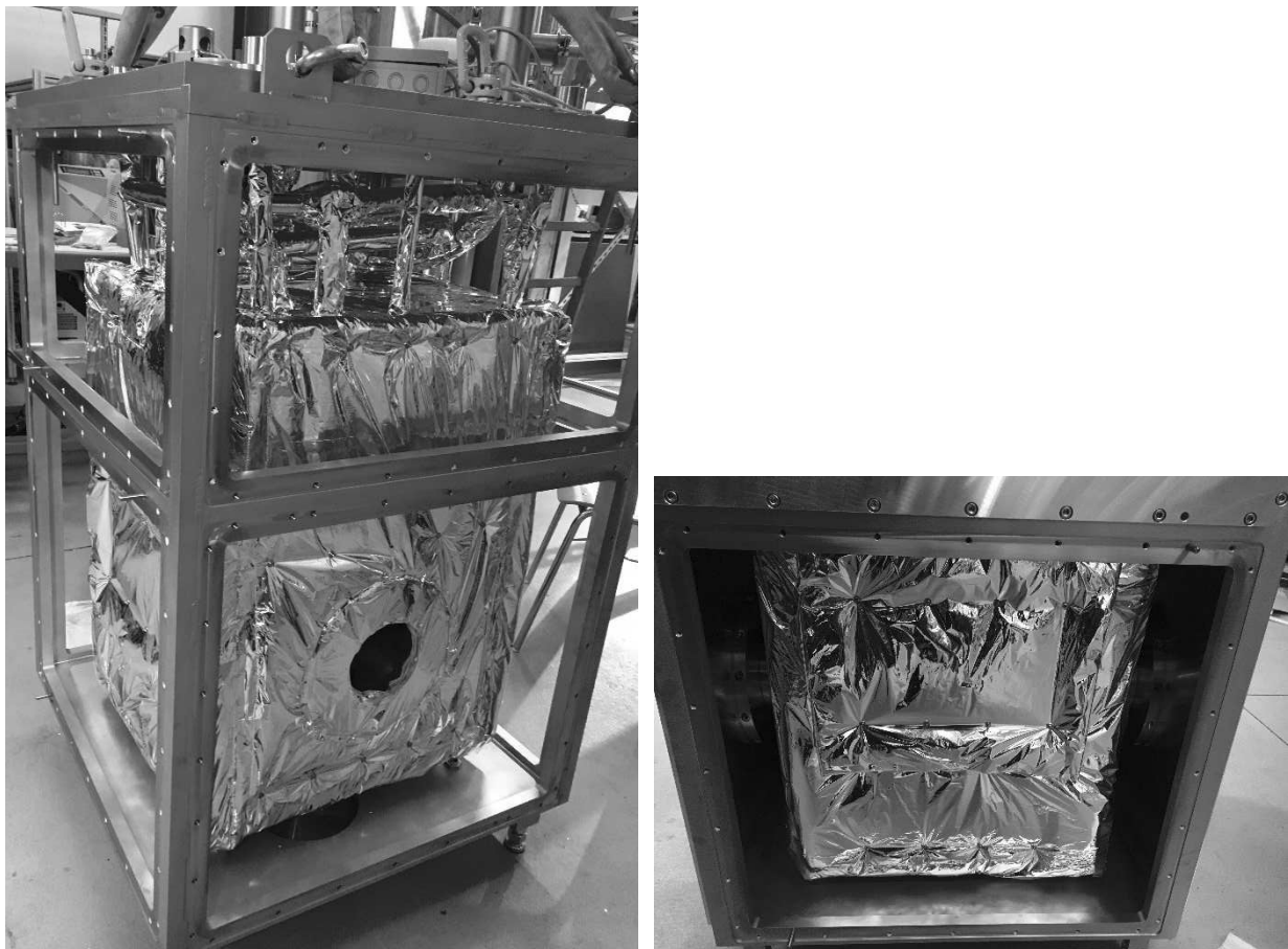
Abbildung 13: Montierter CCC-Kryostat im Vakuum-Gestell: links – ohne Al-Platten und rechts – mit montierter UHV-Rohrbaugruppe
