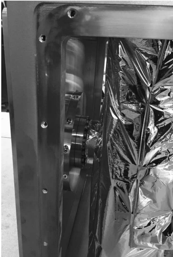
Abbildung 16: Blick durch das untere Fenster auf die zu lösende Flanschverbindung an der UHV-Rohrbaugruppe
