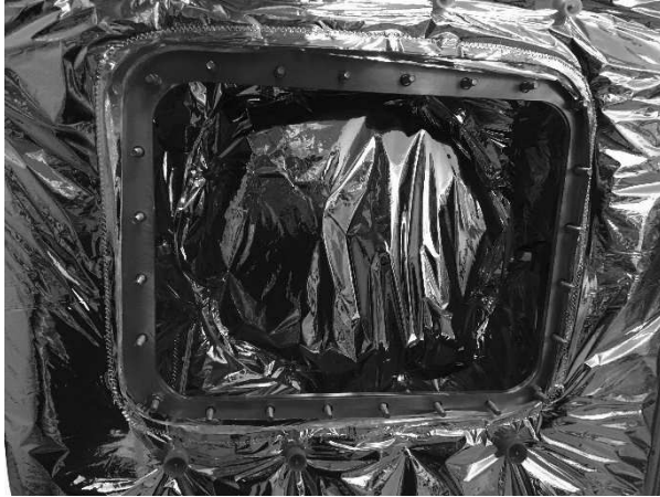
Abbildung 24: Revisionsluke am Thermischen Schild ohne Revisionsplatte
