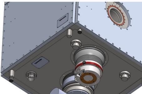
Abbildung 29: Position Typenschild / zwei Möglichkeiten
