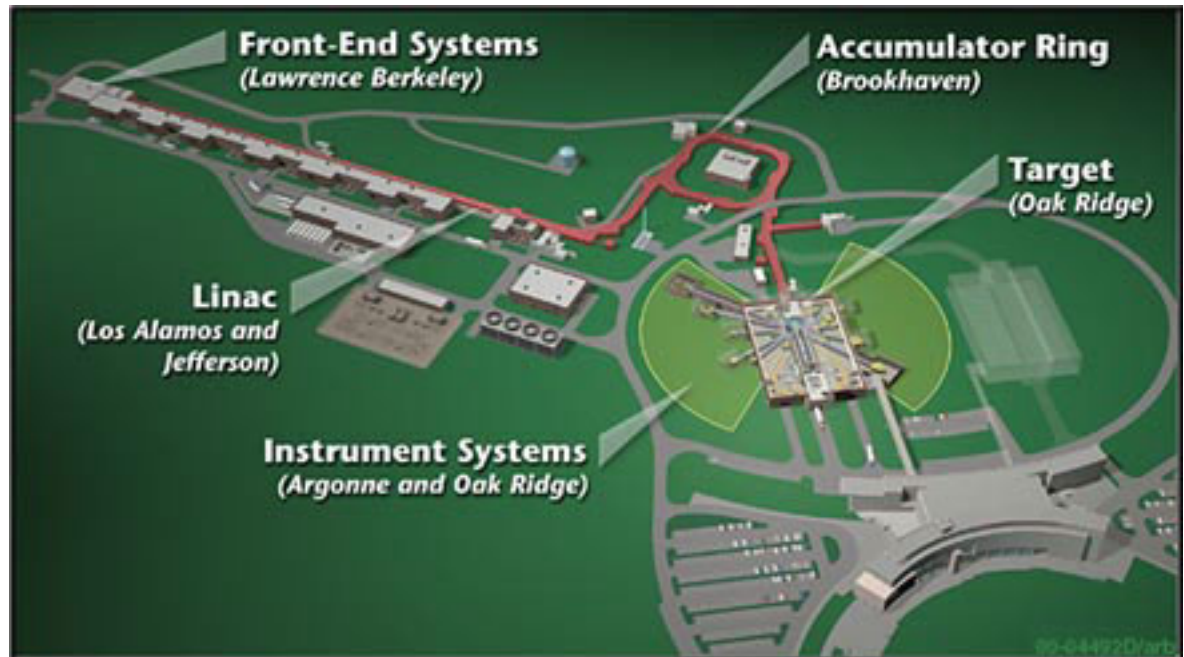
Abbildung 6.33: Layout der in Bau befindlichen amerikanischen Spallationsneutronenquelle SNS.
