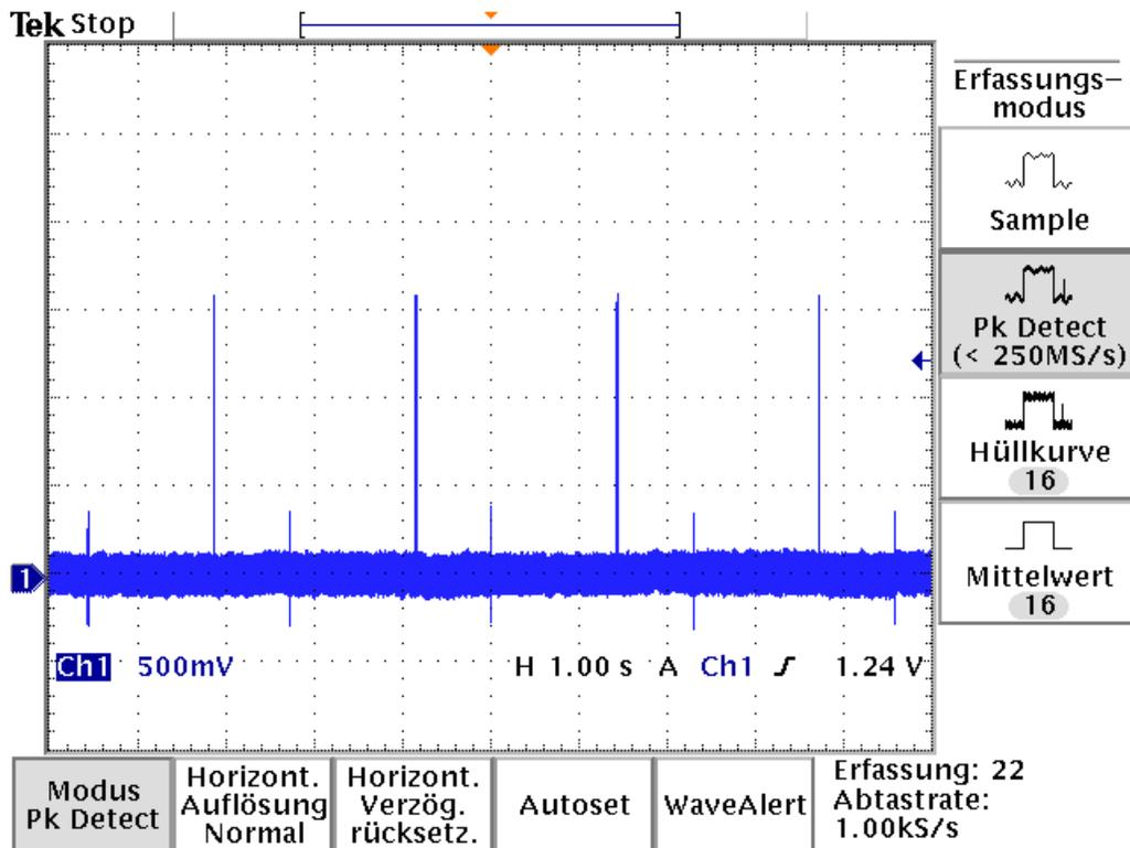
**Abb. 1** GS09DT-ML an Hand-Steuerbox, Monitor-Ausgang  $U_{out}$  bei AUTO-Betriebsart
