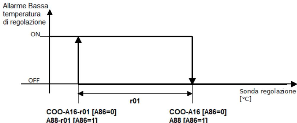
L'alarme est déclenchée si la sonde de contrôle passe en dessous de la valeur (COO-A16)-r01 si vous utilisez les seuils relatifs (A86 = 0), ou A88-r01 si vous utilisez les seuils absolus (A86 = 1) pendant un temps A17. Elle est désactivée lorsque la sonde de contrôle atteint la valeur COO-A16 si vous utilisez les seuils relatifs (A86 = 0), ou A88 si vous utilisez les seuils absolus (A86 = 1). Avertissement seulement.
