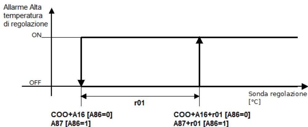
L'alarme est déclenchée si la sonde de contrôle dépasse la valeur  $(COO+A16)+r01$  si vous utilisez les seuils relatifs ( $A86 = 0$ ), ou  $A87+r01$  si vous utilisez les seuils absolu ( $A86 = 1$ ) pendant un temps  $A17$ . Elle est désactivée lorsque la sonde de contrôle passe en dessous de  $COO+A16$  si vous utilisez les seuils relatifs ( $A86 = 0$ ), ou  $A87$  si vous utilisez les seuils absolu ( $A86 = 1$ ). Avertissement seulement.
