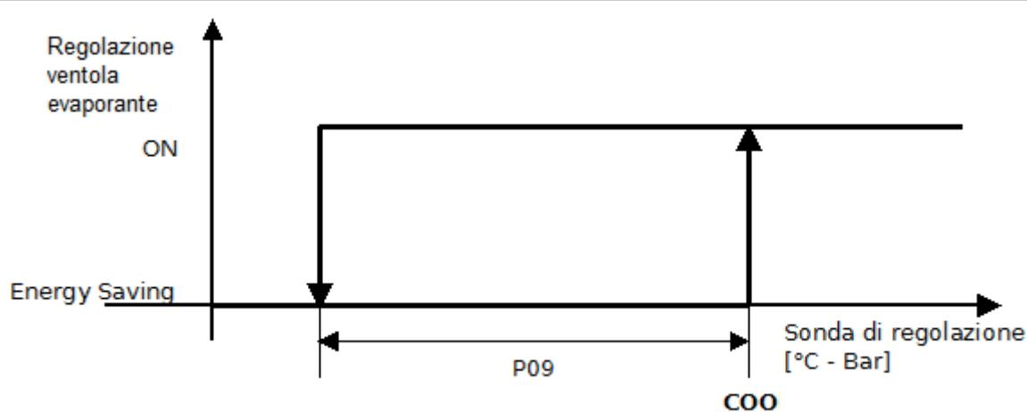
Une fois le mode Économie d'énergie sélectionné (**P01>0**), lorsque la température de contrôle descend en dessous de la valeur **COO-P09**, le ventilateur alterne entre 15 secondes de fonctionnement et **P01** minutes d'inactivité. À chaque cycle, le système vérifie que la température de contrôle est inférieure à la Valeur de consigne (**COO**).
