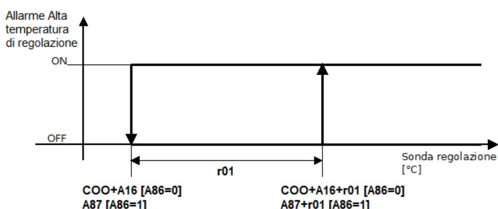
L'allarme si attiva se la sonda di regolazione supera il valore  $(COO+A16)+r01$  se si usano i set relativi ( $A86 = 0$ ), oppure  $A87+r01$  se si usano i set assoluti ( $A86 = 1$ ) per un tempo A17. Si disattiva quando la sonda di regolazione scende sotto il valore  $COO+A16$  se si usano i set relativi ( $A86 = 0$ ), oppure  $A87$  se si usano i set assoluti ( $A86 = 1$ ). Solo warning.
