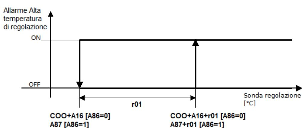
Der Alarm wird aktiviert, wenn der Regelfühler Werte über  $(COO+A16)+r01$  misst bei relativen Schwellwerten ( $A86 = 0$ ) oder  $A87+r01$  bei absoluten Schwellwerten ( $A86 = 1$ ) für eine Dauer von A17. Der Alarm wird deaktiviert, wenn der Regelfühler Werte unter  $COO+A16$  misst bei relativen Schwellwerten ( $A86 = 0$ ) oder  $A87$  bei absoluten Schwellwerten ( $A86 = 1$ ). Nur Warnung.
