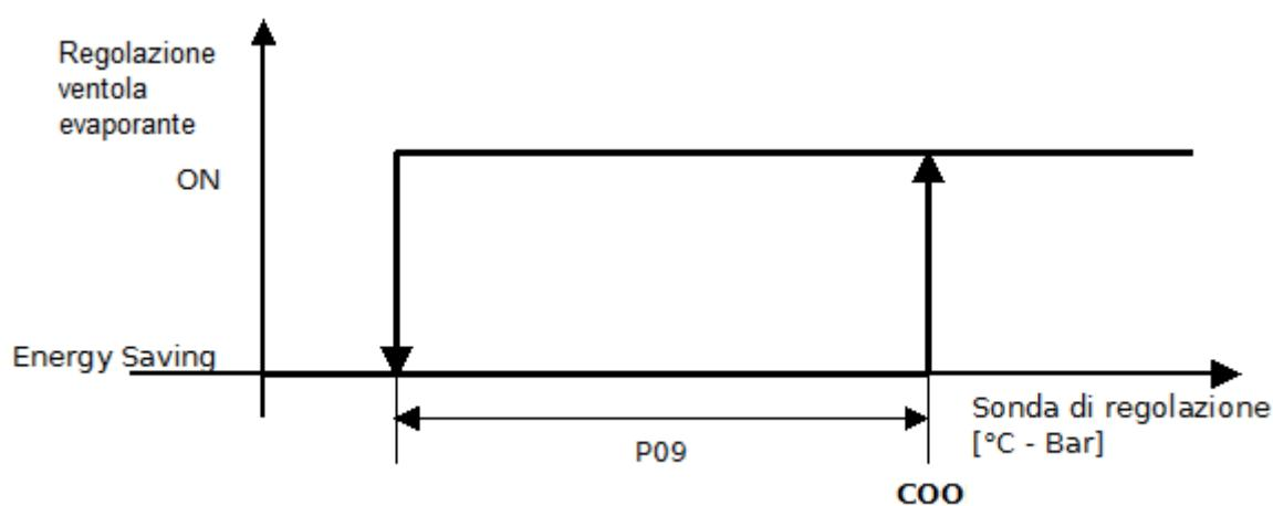
Während der Einstellung des Energy Saving Modus (**P01>0**), wechselt der Ventilator wenn die Regelungstemperatur unter den Wert **COO-P09** sinkt, zwischen 15 sekundigem Betrieb auf **P01** Minuten Inaktivität. Bei jedem Zyklus wird überprüft, ob die Regelungstemperatur unterhalb dem Sollwert (**COO**) liegt.
