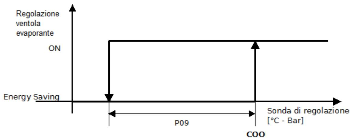
Una vez configurado el modo de funcionamiento con «Ahorro de energía» (**P01>0**), cuando la temperatura de ajuste es inferior al valor **COO-P09**, el ventilador alterna 15 segundos de funcionamiento con **P01** minutos de inactividad. En cada ciclo se comprueba que la temperatura de ajuste sea inferior al punto de ajuste (**COO**).
