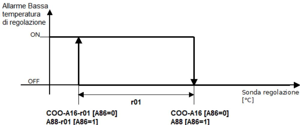
La alarma se activa si la sonda de ajuste desciende por debajo del valor (COO-A16)-r01 si se utilizan los umbrales relativos (A86 = 0), o A88-r01 si se utilizan los umbrales absolutos (A86 = 1) para un tiempo A17. Se desactiva cuando la sonda de ajuste llega al valor COO-A16 si se utilizan los umbrales relativos (A86 = 0), o A88 si se utilizan los umbrales absolutos (A86 = 1). Solo advertencia.
