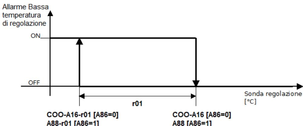
Der Alarm wird aktiviert, wenn der Regelfühler Werte unter (COO+A16)-r01 misst bei relativen Schwellwerten (A86 = 0) oder A88-r01 bei absoluten Schwellwerten (A86 = 1) für eine Dauer von A17. Der Alarm wird deaktiviert, wenn der Regelfühler den Wert COO-A16 erreicht bei relativen Schwellwerten (A86 = 0) oder A88 bei absoluten Schwellwerten (A86 = 1). Nur Warnung.
