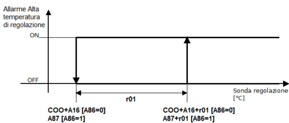
La alarma se activa si la sonda de ajuste supera el valor  $(COO+A16)+r01$  si se utilizan los umbrales relativos ( $A86 = 0$ ), o  $A87+r01$  si se utilizan los umbrales absolutos ( $A86 = 1$ ) para un tiempo A17. Se desactiva cuando la sonda de ajuste desciende por debajo del valor  $COO+A16$  si se utilizan los umbrales relativos ( $A86 = 0$ ), o  $A87$  si se utilizan los umbrales absolutos ( $A86 = 1$ ). Solo advertencia.
