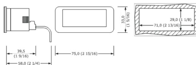
L'installation est conçue sur panneau, avec les supports à clic fournis. L'épaisseur du panneau doit être comprise entre 0,8 et 2,0 mm (1/32 et 1/16 po).
