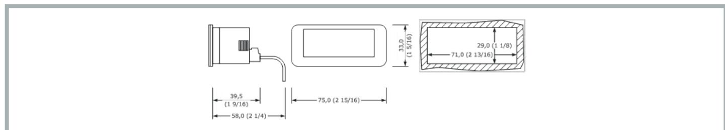
Está prevista la instalación con panel, con los soportes a presión suministrados. El grosor del panel debe estar comprendido entre 0,8 y 2,0 mm (1/32 y 1/16 in).
