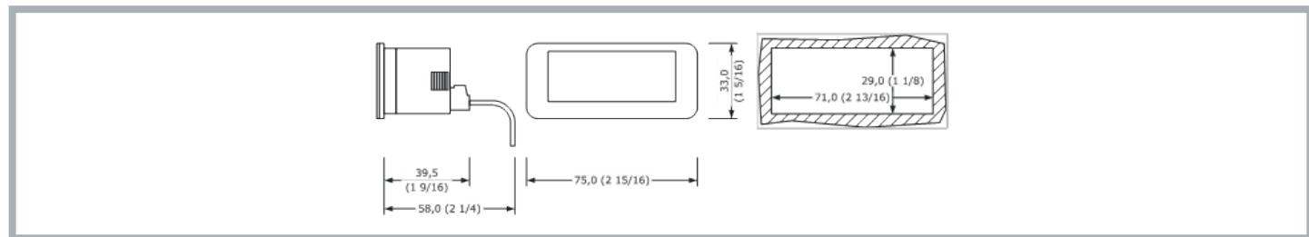
Es handelt sich um ein Tafeleinbau-Gerät. Die Befestigungsbügel sind im Lieferumfang enthalten. Die Dicke der Tafel muss zwischen 0,8 mm und 2,0 mm (1/32 und 1/16 in) liegen.
