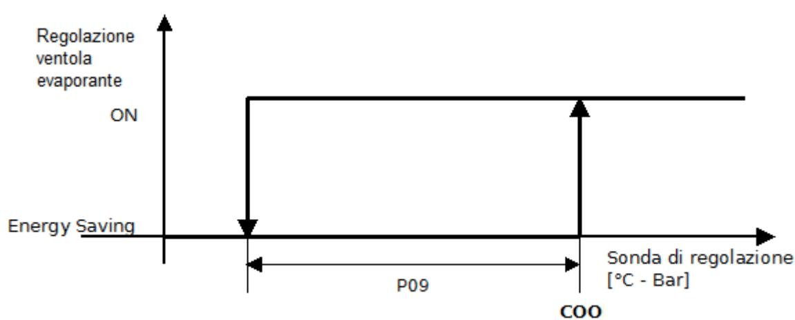
Impostata la modalità di funzionamento in energy saving (**P01>0**), quando la temperatura di regolazione scende al di sotto del valore **COO-P09**, la ventola alterna 15 secondi di funzionamento a **P01** minuti di inattività. Ad ogni ciclo viene verificato che la temperatura di regolazione sia inferiore al Set Point (**COO**).
