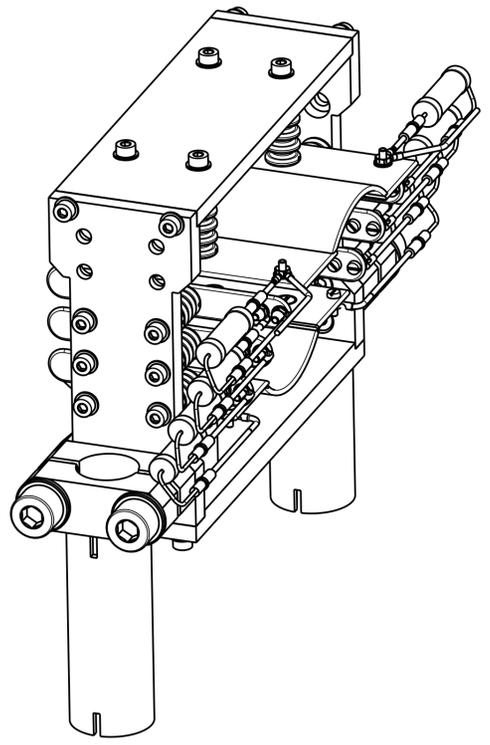
Keine feste Verbindung, Distanzrohr wird bei Montage zum Einhalten der Höhe der Strahlachse eingefügt.
