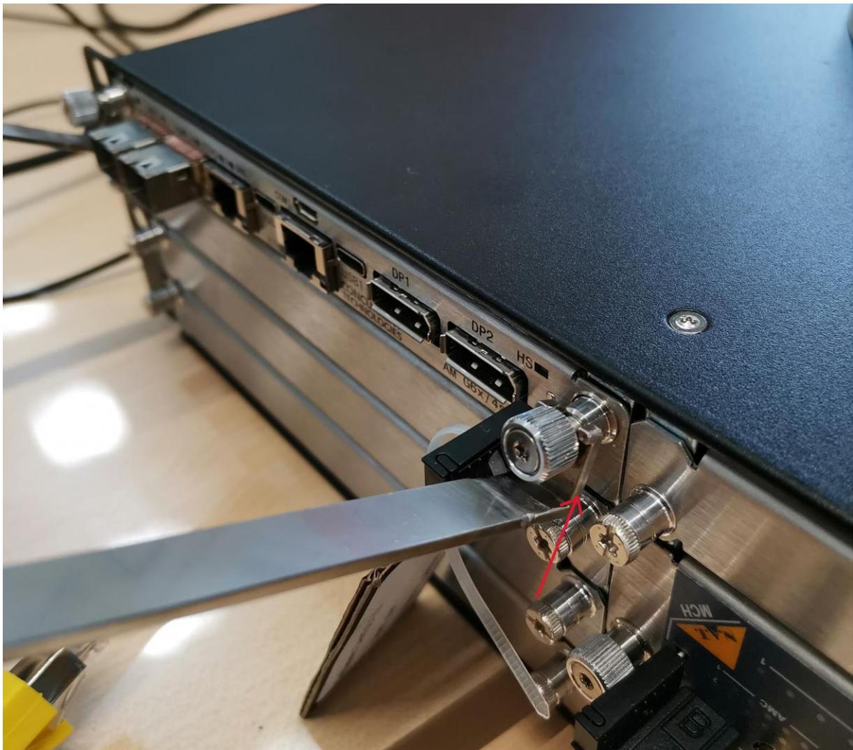
Das Tool in einem 90° Winkel stellen, so das der Schraubenkopf komplett im Montagewinkel sitzt.
