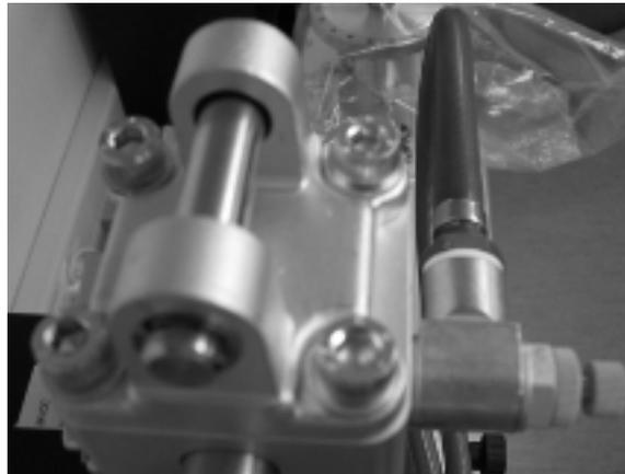
**Abbildung 2: Kranöse am oberen Ende des Pressluftzylinders**
