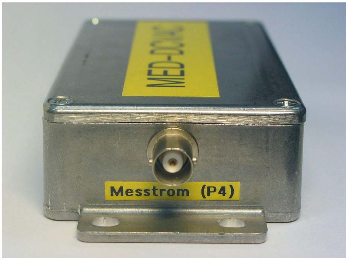
Abbildung 2: Vorverstärker, BNC-Buchse für Messtrom-Eingang
