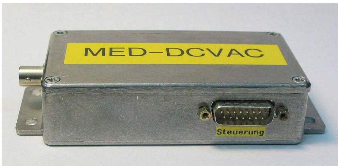
Abbildung 1: Vorverstärker, D-Sub-Gerätestecker für Steuerung und Ausgangssignal
