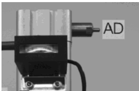
Abbildung 1: Oberer Teil des Pressluft-Zylinders mit Zählwerk und Endlageverriegelung (AD)
