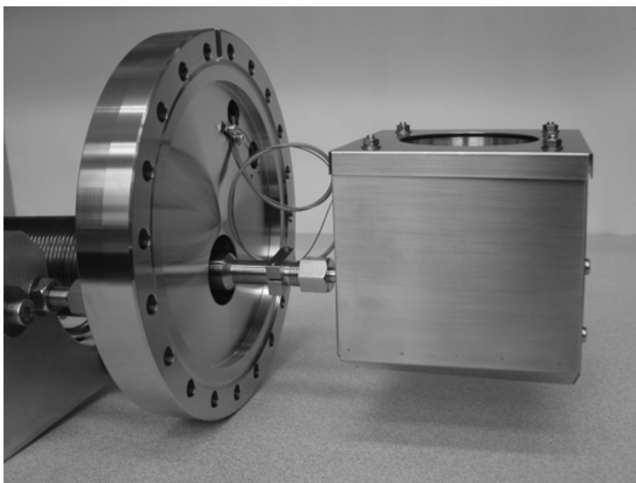
Abbildung 4: Seitenansicht des Faraday-Cups (Strahlrichtung von oben)
