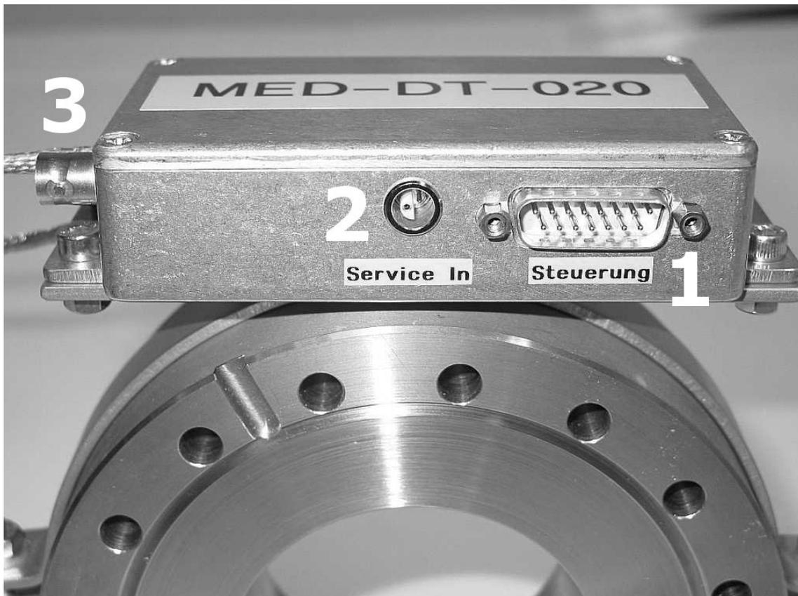
Abbildung 1 AC-Strahlstrom-Transformator mit montierter Verstärker-Elektronik
