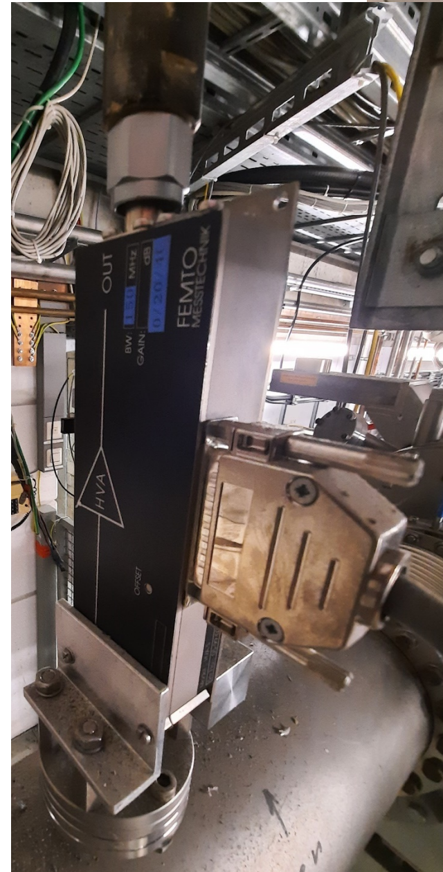
Rohrsonde: Femto ferngesteuert Versorgungsspannungen über Sub-D Stecker! Anpassung notwendig!
