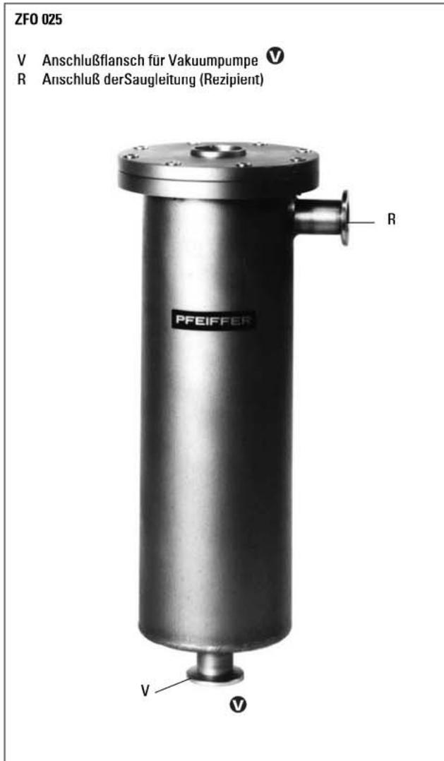
Die Zeolithfalle verhindert durch Adsorption die Rückströmung von Kohlenwasserstoffen aus ölgedichteten zweistufigen Vakuumpumpen mit mineralischem Betriebsmittel zu nachfolgenden Hochvakuum-Bauteilen.
